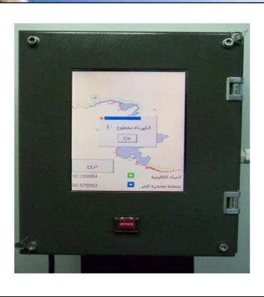
En cas de coupure du courant principal par exemple, une alarme sonore et un message s'affiche sur l'écran pour avertir l'équipage de la nécessité de réparer cette rupture.
